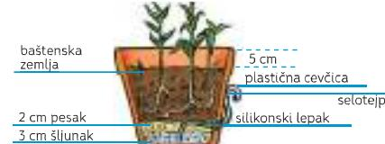
Keramički lonac ili kofa od 10 l se puni slojem šljunka, peska i baštenske zemlje. Provođena cevčica se pričvršćuje za dno kofe i izvodi napoleđe kroz hermetički zatvoren otvor. U lonac se sade biljke iz vlažnih područja kao što su rogoz, obična bokvica i šaš. Kofa sada mora da se navodnjava šest meseci. Prve dve nedelje nivo vode u kofi treba da je visok, zatim tri meseca približno pola visine kofe. Zatim navodnjavajte kofu manje
